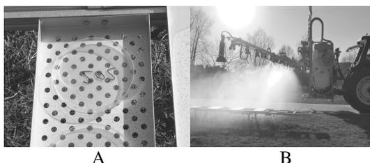
Figura 3. Meccanismo di funzionamento del banco prova: la nuvola di gocce che rimane sospesa nell'atmosfera dopo il passaggio della barra irroratrice (deriva potenziale) si deposita sui captatori del banco prova
