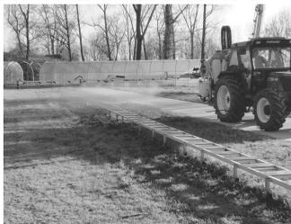
Figura 2. Capsule Petri utilizzate come captatori lungo il banco prova (A) e scoperta automatica dei captatori nel momento in cui la barra raggiunge l'estremità anteriore del banco prova (B)
