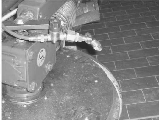
Figura 6. Meccanismi per il controllo dell'erogazione della miscela erbicida
