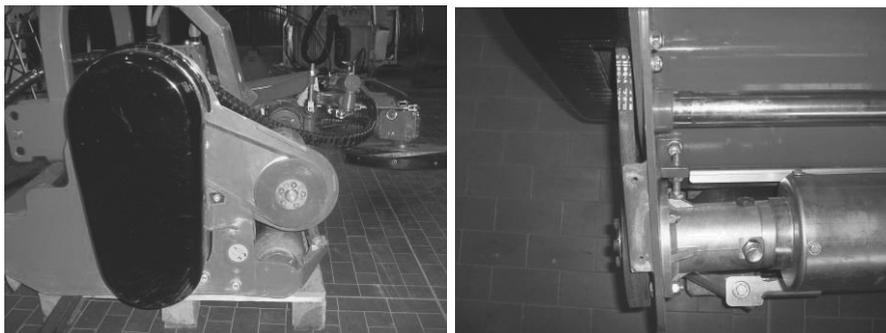
Per azionare il dispositivo di taglio con asse verticale risulta ancora necessaria una rotazione della direzione del moto di  $90^\circ$ , da orizzontale longitudinale a verticale. Quest'ultima viene ottenuta mediante un'altra coppia conica posizionata sul disco. Il collegamento fra le 2 coppie coniche è ottenuto con l'impiego di un giunto cardanico multiplo.
