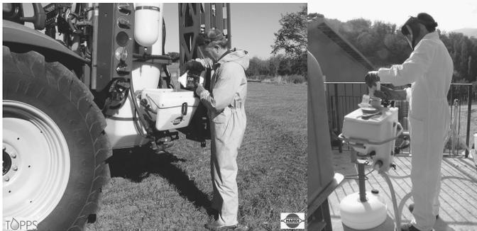
Al fine di preservare l'area dell'azienda agricola dove si effettuano le operazioni di riempimento dell'irroratrice dalla contaminazione legata ad eventuali perdite o sversamenti di prodotto fitoiatrico, è raccomandabile realizzare una apposita piazzola in cemento e dotarla di un sistema per la raccolta delle acque contaminate con agrofarmaci. La stessa area attrezzata può essere usata anche per effettuare le operazioni di lavaggio dell'irroratrice in azienda al termine del trattamento.
