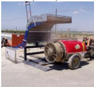
Figura 4 - Prototipo con la barra richiusa (tesi T2)
