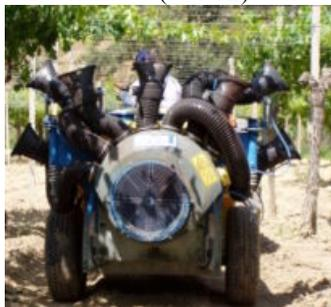
Figura 5 - Prototipo con la barra distesa (tesi T3)
