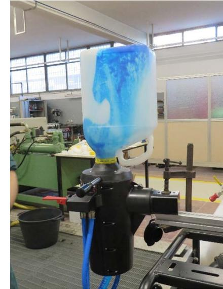
c) Riempimento di CTS e tubo di collegamento con irroratrice con 10 l di acqua pulita.
