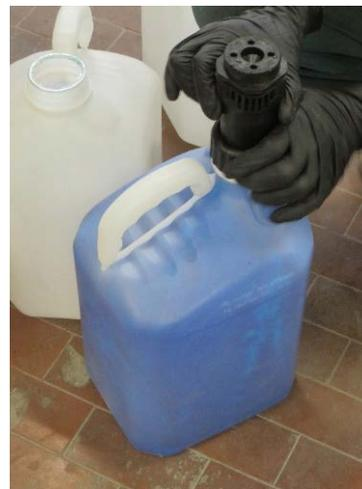
**Liquido di prova:** soluzione acquosa di polisaccaridi e metil-cellulosa, carbonato di sodio, antibatterico e tracciante blu (Patent E133).
