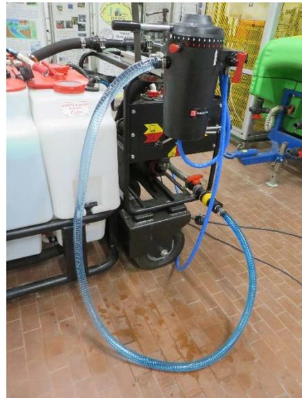
d) Trascorse 6 ore raccolta di tutto il liquido e successiva analisi spettrofotometrica per quantificare l'entità del residuo.
