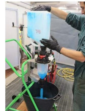
c) Determinazione del residuo finale di prodotto ancora presente nel contenitore al termine di tale operazione attraverso un ulteriore accurato risciacquo del contenitore con un volume noto di acqua (1 litro) e misurazione della concentrazione del colorante nell'acqua di lavaggio attraverso analisi spettrofotometrica.
