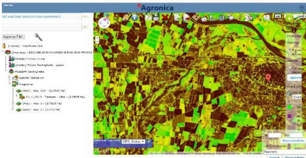
**Generazione di mappe di prescrizione in base a analisi mappe di produzione, o foto aeree/satellitari con indici vegetativi o di acqua/terreno, etc..**
