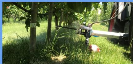
Barra VIMAS con due ugelli a ventaglio OC12 @5,5 bar con apertura comandata da tastatore
